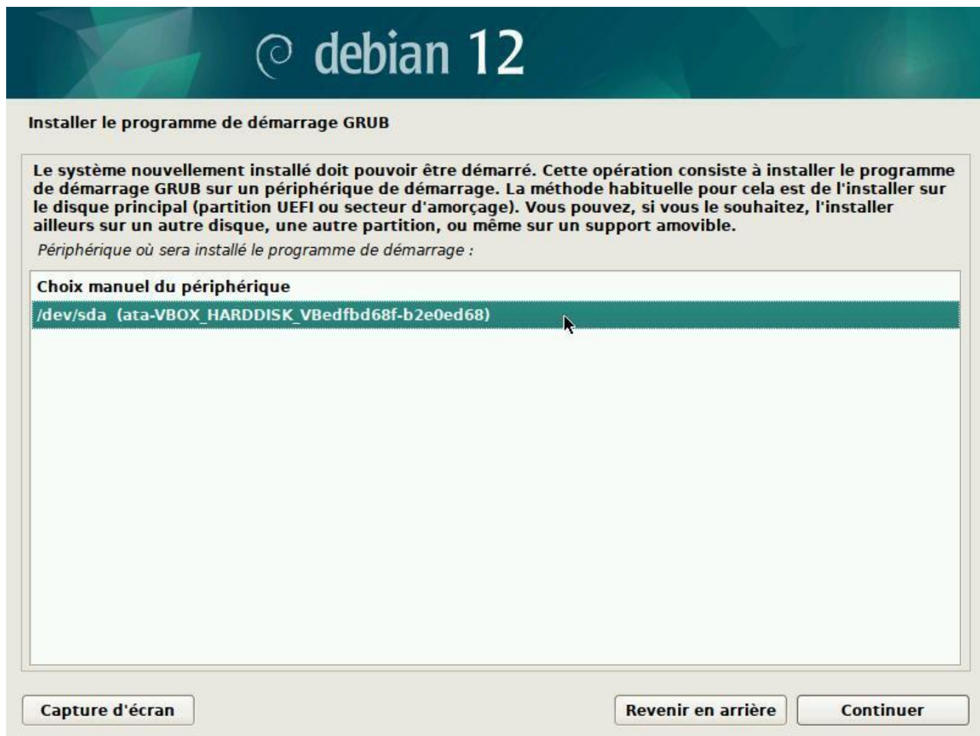
Installation : choix du disque pour GRUB
